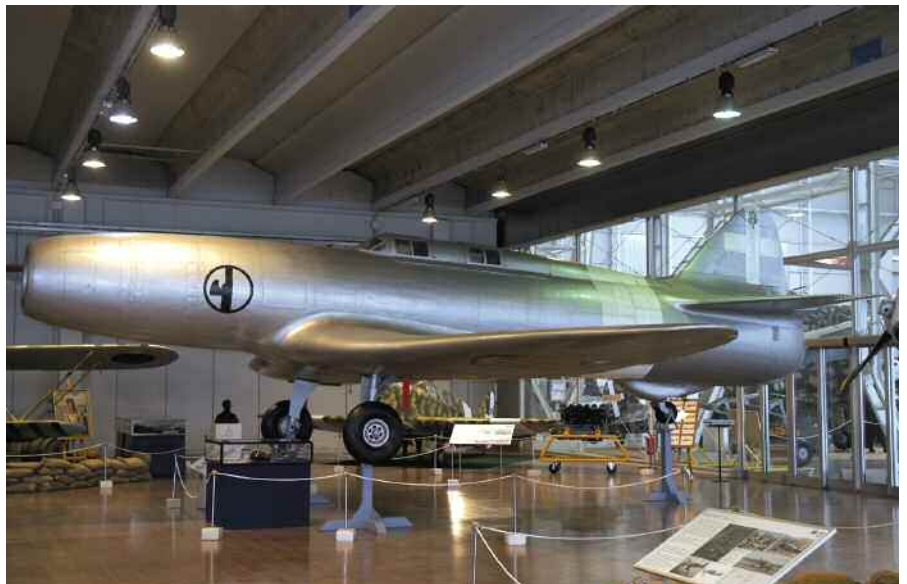
El extraordinario Caproni-Campini C.C.1 fue uno de los pioneros de la aviación a reacción. Sólo superado en el tiempo por el avión experimental alemán He 178V1, utilizó una fórmula única para accionar el compresor mediante un motor de explosión.
