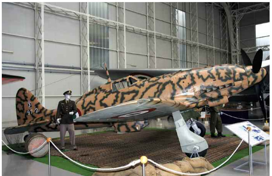
El Macchi MC.202 Folgore muestra sus inconfundibles líneas que delatan su propulsor Daimler Benz. Va pintado con el camuflaje norteafricano de la Regia Aeronautica.
